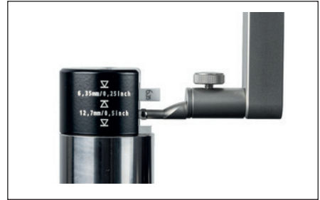
Fig. 13 Posicionamento do bloco de ajuste ao calibrar com ranhura
