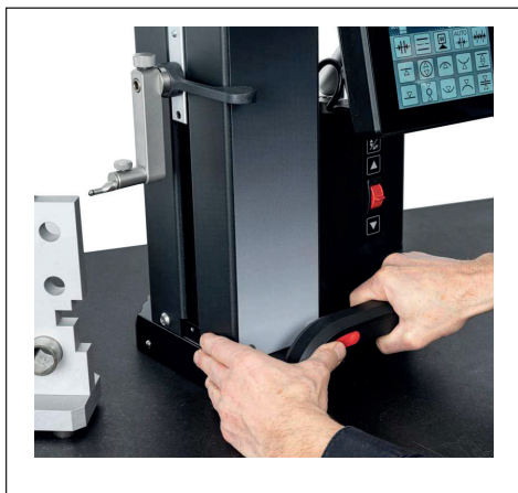
Fig. 8 Movimentação do equipamento de medição de altura com colchão de ar ativado
