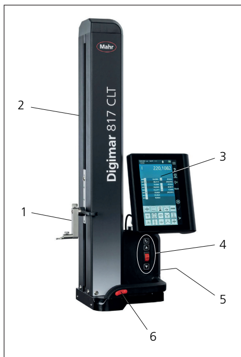
Fig. 1 Elementos do equipamento de medição de altura
